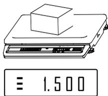
Масса в допуске (в дозирующем режиме выдаётся сигнал S0)
