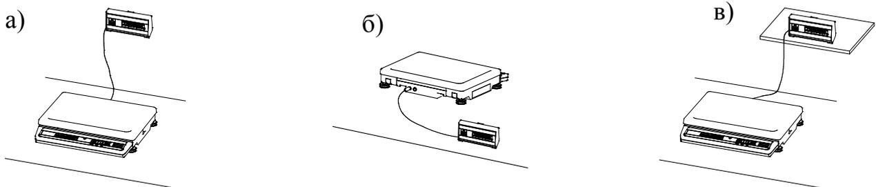
Рис. 7.5 - Варианты установки выносного индикатора
