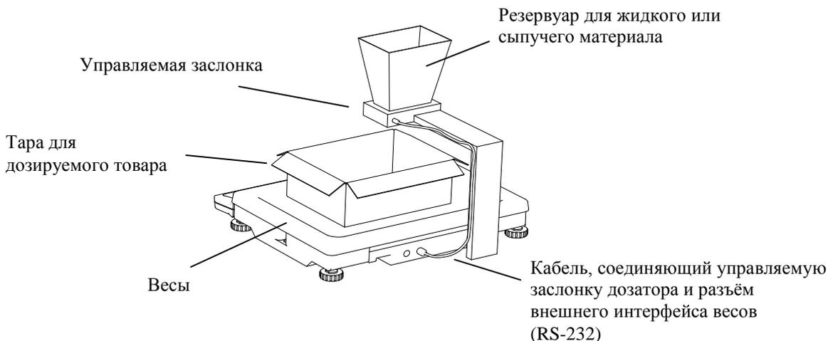
Рис. 7.2 – Подключение весов к дозирующему устройству
